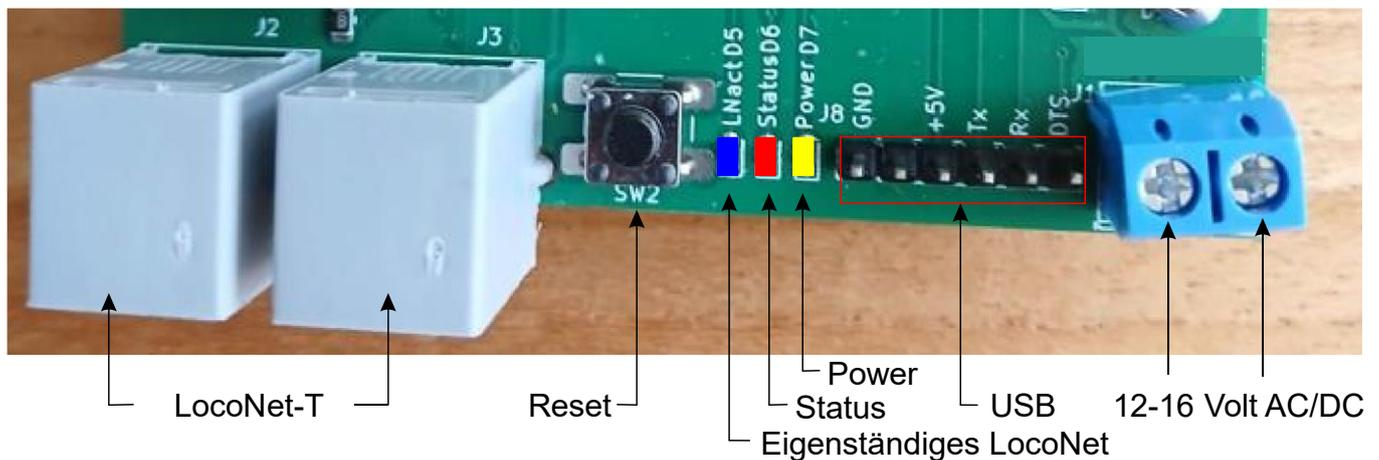
Im Konfigurationsmodus leuchtet die Status-LED immer. Im Normalmodus ist sie aus und blinkt kurz, wenn LocoNet-Signale gesendet werden. Im Stoppmodus ist sie ebenfalls an.
