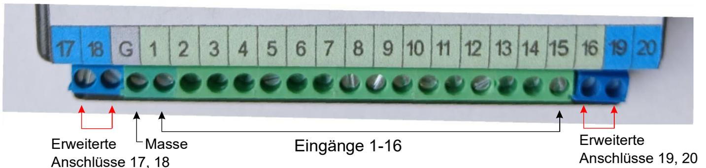
Die **Masse** muss mit der Masse des Moduls verbunden werden, das die Eingangssignale liefert. In der Regel handelt es sich dabei um ein Stromfühlermodul wie das Okkie oder OkkieNext.
