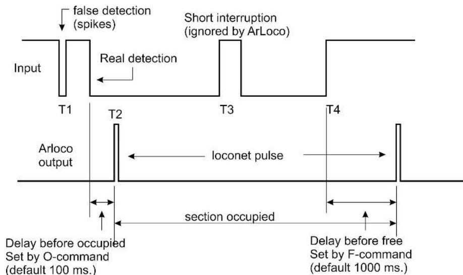
La détection de courant étant la principale méthode utilisée pour la détection d'occupation, les entrées de LocoNext sont généralement connectées aux sorties d'un dispositif de détection de courant. Cependant, LocoNext fonctionne aussi bien lorsqu'un ILS (interrupteur reed) ou une barrière infrarouge est utilisé comme moyen de détection.
