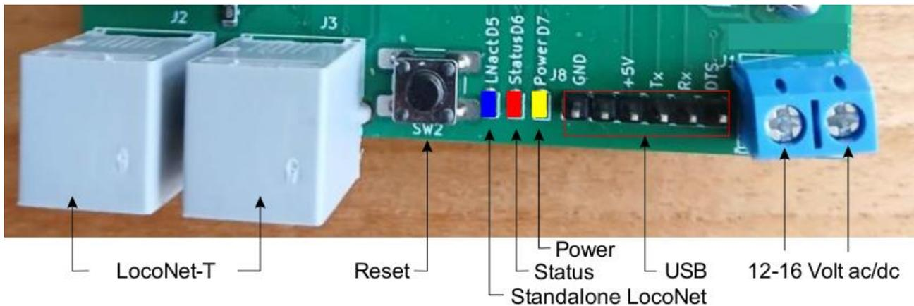
En mode configuration, la LED d'état est toujours allumée. En mode normal, elle est éteinte et clignote brièvement lors de l'envoi de signaux LocoNet. En mode « STOP », elle est également allumée.
